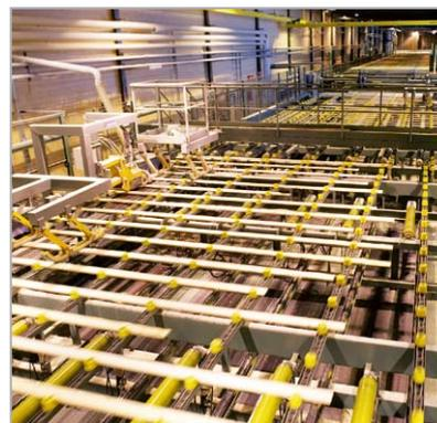
На фото безступенчатая торцовка комлевой части пиломатериалов в диапазоне 0–900 мм.
