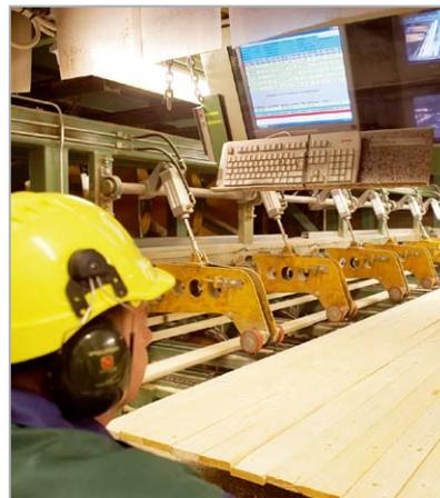
На фото устройство поштучной выдачи пиломатериалов. Заказчик может выбрать устройства поштучной выдачи из предлагаемых образцов согласно техническим требованиям.
