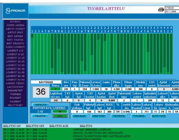
На снимке показано табло показаний одного из этапов сортировки. По монитору компьютера можно наблюдать за процессом и при необходимости вносить корректировки. С помощью таких или подобных программ возможно управление и изменение различных этапов работы лесопильного производства.
