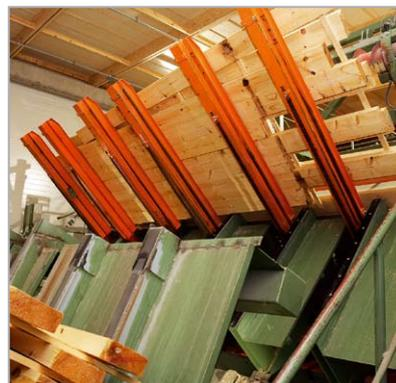
На фото устройство разборки штабеля оборудовано вспомогательным разгрузочным устройством, при помощи которого время смены штабелей сокращается до нуля. Линия сухой сортировки работает постоянно, т.к. пиломатериал подается без перерыва на смену штабеля.
