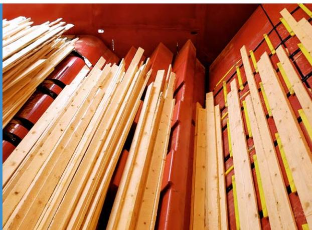
Для более бережной сортировки пиломатериалов линия пакетоформирования может быть снабжена устройством шаговой подачи. Устройство шаговой подачи совместно с двойным разборочным элеватором значительно повышает производительность линии.
