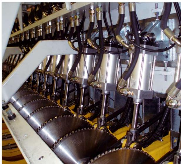
На линии сортировки сырых пиломатериалов торцовка производится по ближайшему стандартному размеру длины. При этом, из обрезков, проходящих через рубительную машину, получается еще один вид готовой продукции – технологическая щепа, которая также является продукцией и приносит прибыль. На фотографии показан один из эффективных способов торцовки пиломатериала при помощи триммера. При значительных производственных скоростях рекомендуется торцовка пиломатериалов способом Jartek Free Cut.
