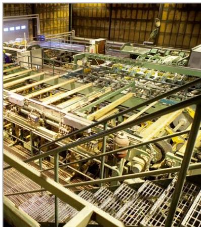
На фото устройство подачи реек на рейкоукладывающий механизм. Подача реек может выполняться автоматически, как показано на фотографии, так и в полуавтоматическом режиме когда заполнение кассет реек происходит вручную.
