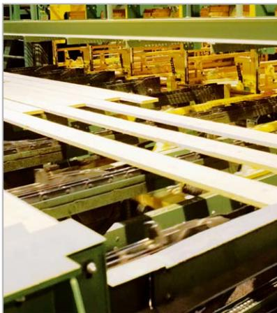
На фото щитоукладочный механизм. Производительность щитоукладочного механизма рассчитывается исходя из технических требований клиента. Положение кассет реек возможно установить автоматически для каждого типоразмера.
