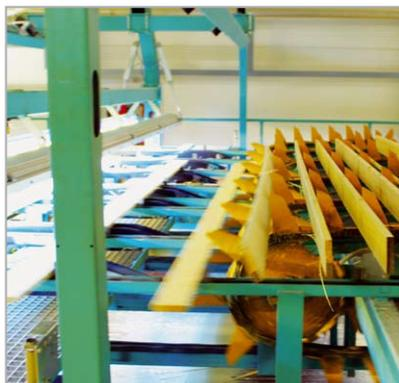
Полностью автоматическая система определения качества по пластям и граням состоит из двух групп сканирующих камер и кантователей между ними.
