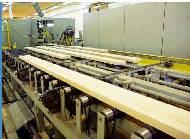
На снимке линия SMB для больших сечений п/м, например для изготовления клееного строительного бруса.
