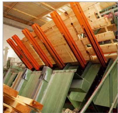
Kuvassa on rimakuorman purkulaitteisto apupurkaimilla varustettuna. Näin saadaan kuorman vaihto aika nollaan. Tasaamo käy jatkuvasti ilman pakettin vaihdon aiheuttamia katkoksia.
