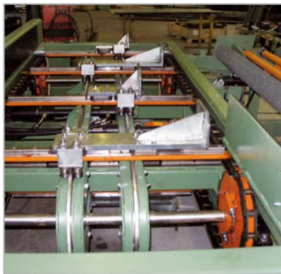
Jartek Free Cut on vapaakatkonta laitteistomme lippulaiva. Yhdistettynä trimmeriin sillä saadaan kappaleille tarkka portaaton katkenta tehokkaasti.
