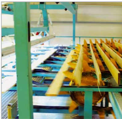
Automaattinen kameralaadutusasema, jota edeltää kappaleen kääntäjä sekä toinen laadutusasema.
